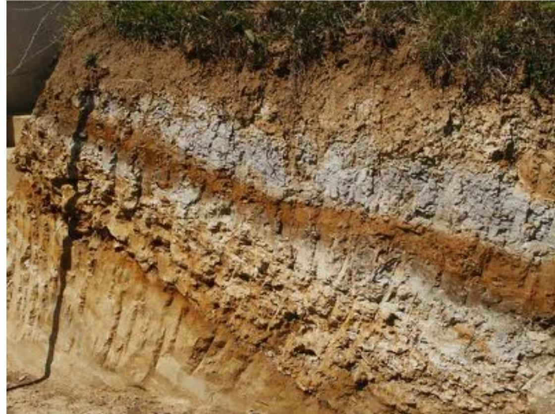
**Exemple, un sol d'argile plastique dans lequel on va creuser une tranchée, les parois de la tranchée vont rester verticales, le sol présente une cohésion il ne va pas s'écouler comme du sable.**
