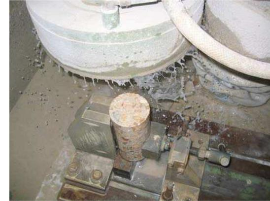
**Figure 7 : Surfaçage des éprouvettes**
