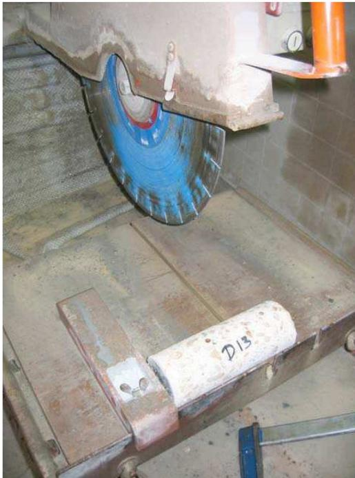
**Figure 6 : tronçonnage à la scie diamant**
