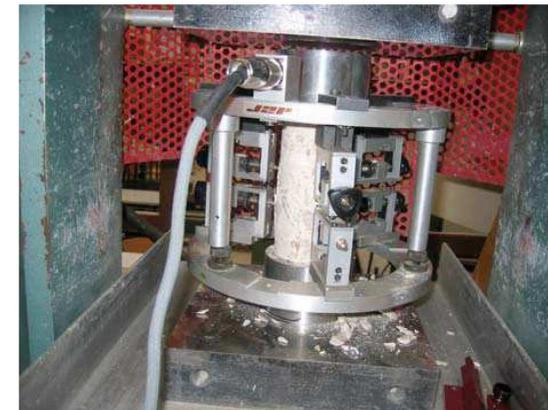
**Figure 8 : Extensomètre J2P pour la mesure du module d'Young sur éprouvettes**
