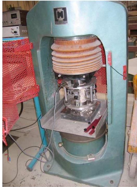
**Figure 9 : Presse hydraulique 2500kN (Controlab)**
